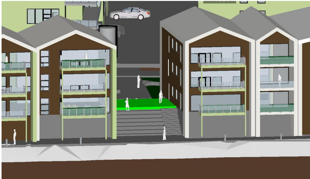
Figur 4.5 Høyden av trappen er ca. 3 m fra bakkenivå
