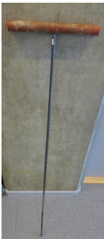
Figur 2: Dybdemåler i stål. Lengde ca. 110cm
