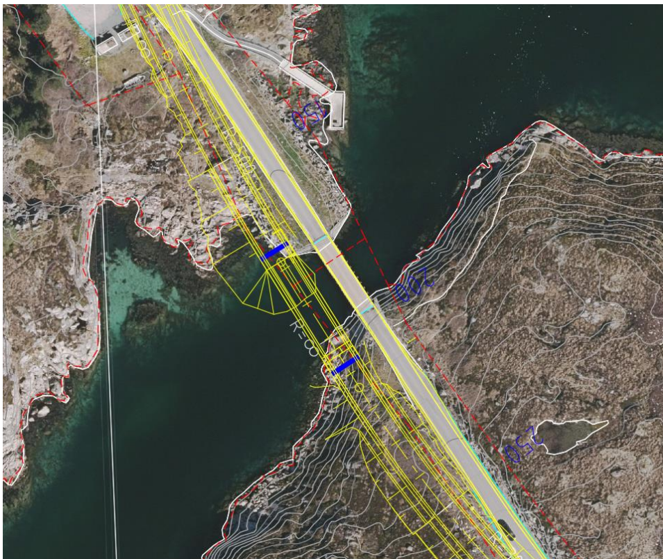
Figur 4-4: Skisse av løsning for ny bru i ny trasé vest for dagens bru.
