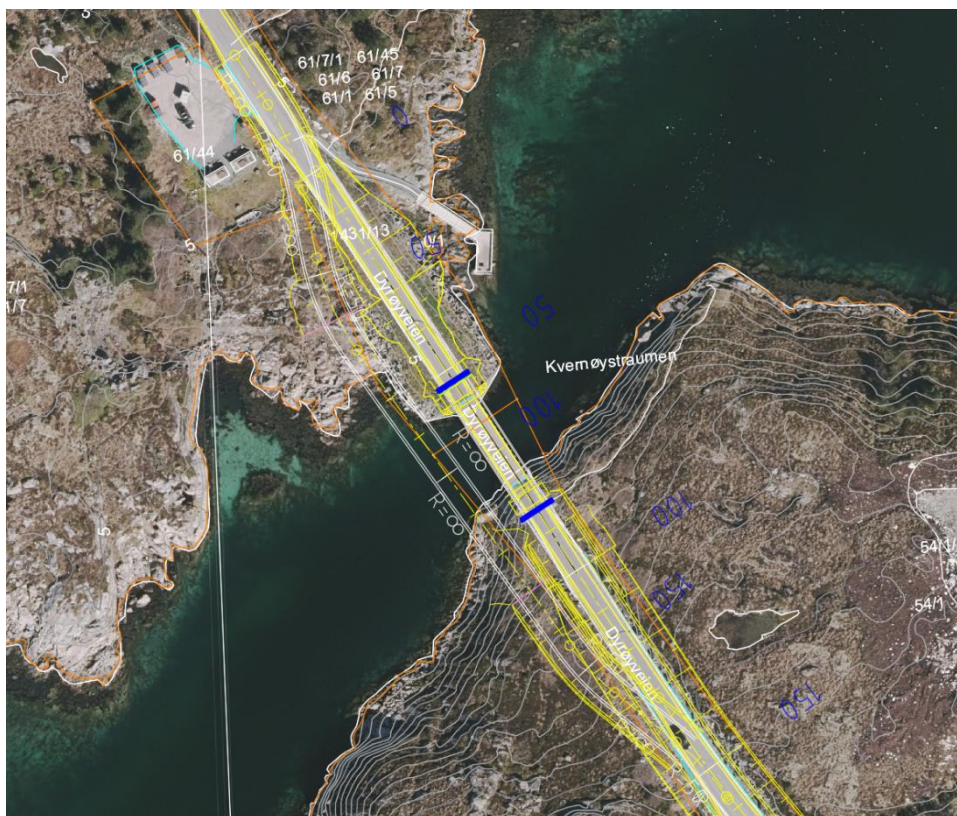
Figur 4-5: Skisse av løsning for ny bru i samme trasé som dagens bru.
