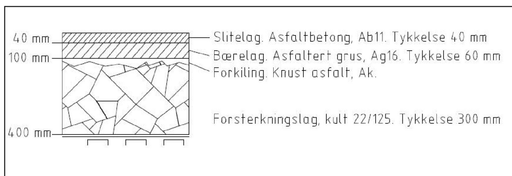
Figur 4: Overbygning i rømningstunnelen
