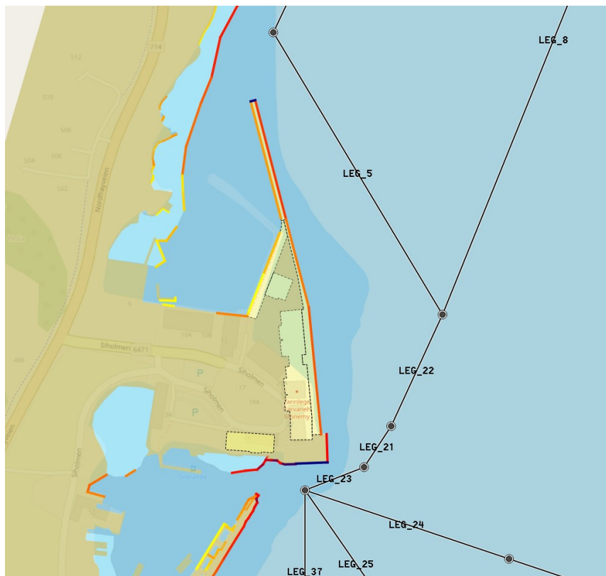
Figur 17: Resultatplott av støt mot Siholmen (relativ fargeskala: gul farge indikerer lavere sammenstøtfrekvens mens rødt og blått indikerer høyere sammenstøtfrekvens)
