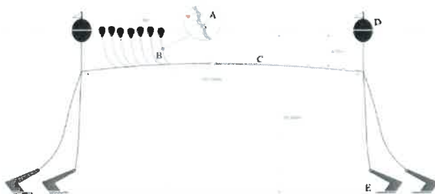
Figur 3 skjematisk skisse av første "MacroAlgal Cultivation Rig (MACR-versjon1) designet og konstruert av Ocean Rainforest. Konstruksjonen er egnet for tare dyrking på bølge-eksponerte lokaliteter. Vertikale dyrkingstau (B) er festet til et rammeverk (C) som blir holdt i en vertikal posisjon ved hjelp av blåser (D) med stål-anker festet til bunn (E) som holder posisjonen til riggen.
