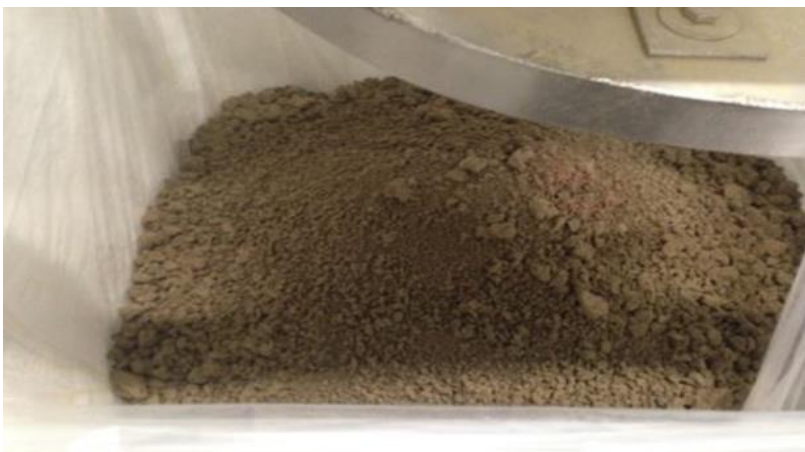
FIGUR 26 - TØRKET SLAM FRA SLAMTØRKEANLEGG. BILDE: YNGVE PAULSEN
