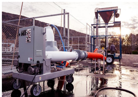
FIGUR 19 – FISKEPUMPE FOR LEVERING AV FISK OG INTERNFORLYTTING AV FISK I ANLEGGET
