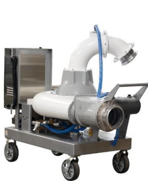
FIGUR 19 – FISKEPUMPE FOR LEVERING AV FISK OG INTERNFORLYTTING AV FISK I ANLEGGET
