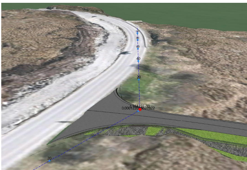
Figur 34: Ny avkjørsel til fv. 714 og siktforhold mot nord. Ny g/s-veg under utbygging på nordsiden av fylkesvegen
