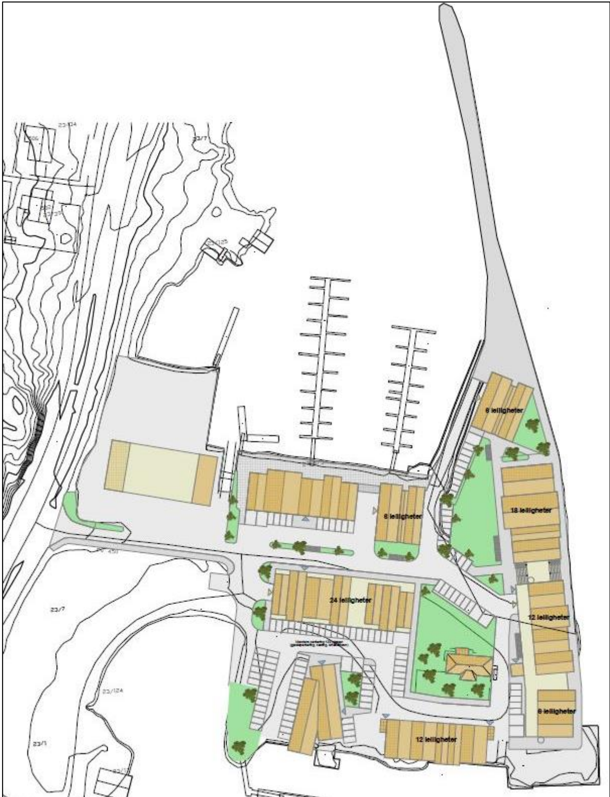
Figur 13. Situasjonsplan fra On Arkitekter og Ingeniører AS med 84 leiligheter, grøntareal og parkeringsareal.
