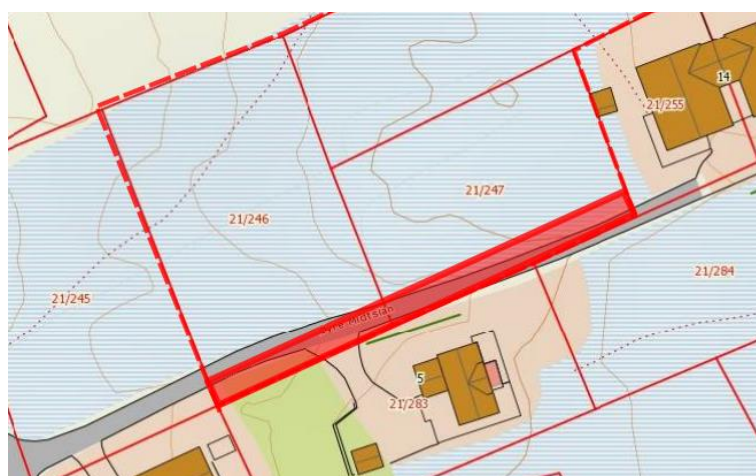
Figur 9 Kart som viser justert trase for veg (i rødt, må knyttes sammen med eksisterende veg)
