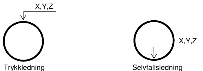
Figur 1. Måling av ledningshøyde.
