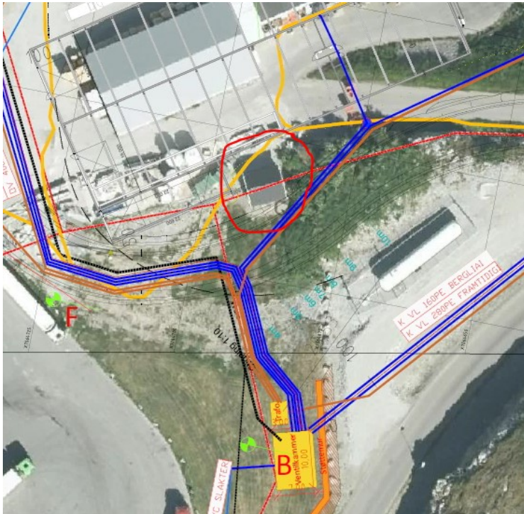
Bilde 1 Eksisterende ventilkammer med rød ring. Eventuelt nytt ventilkammer i gult markert med B
