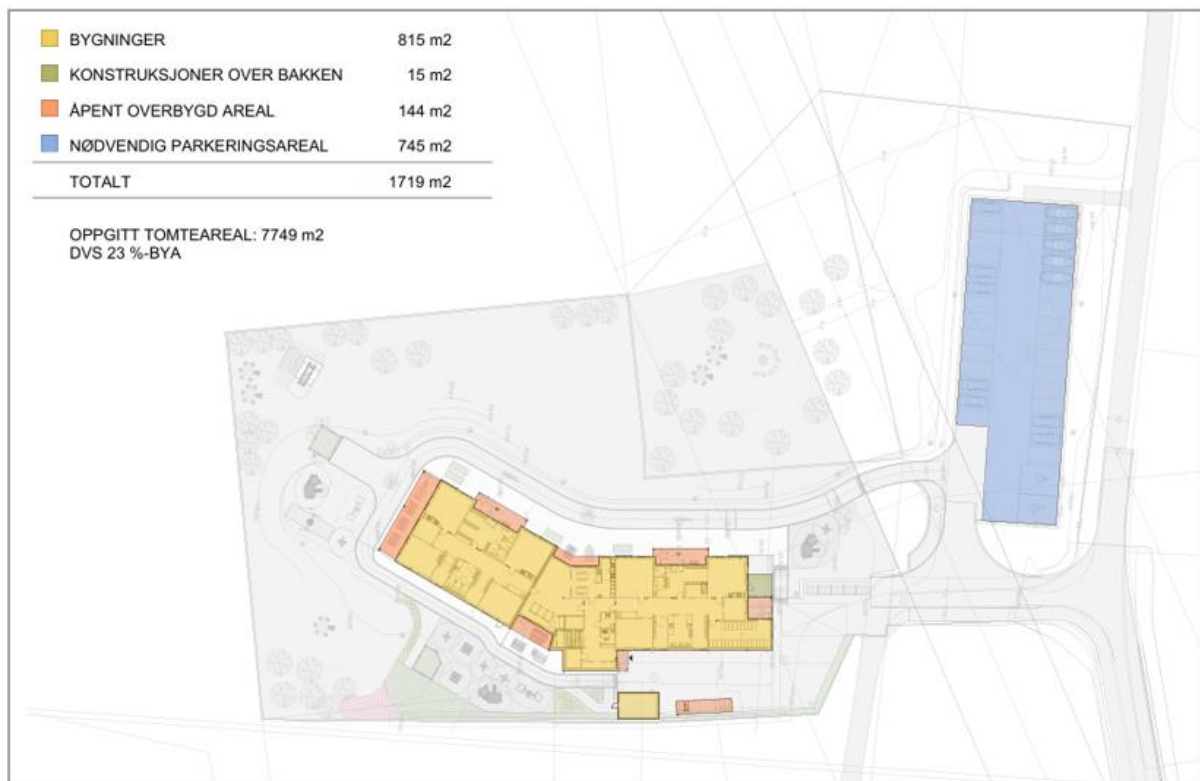
Figur 12 Beregning av utnyttelse.
