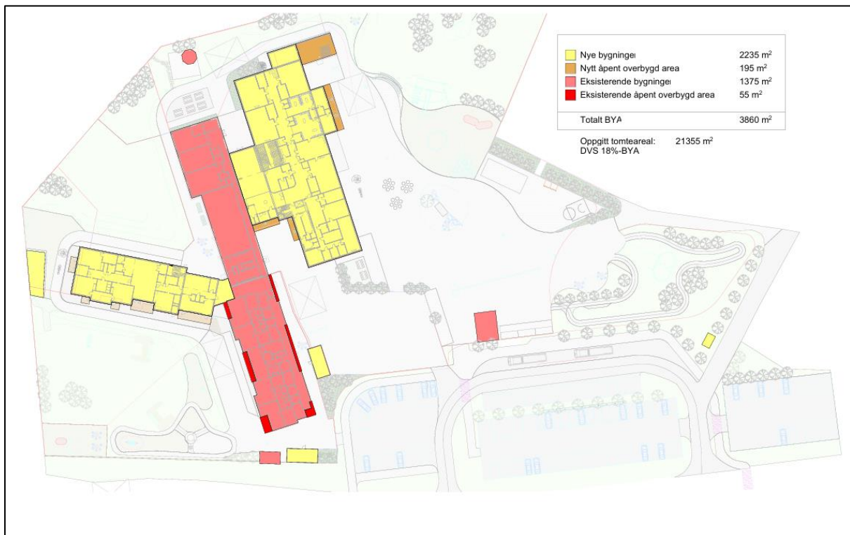
Figur 14 Beregning av utnyttelse.
